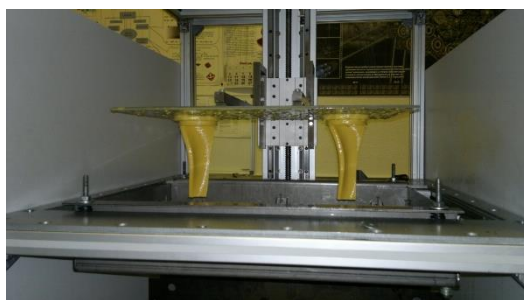
Рис. 1. Установка для изготовления сложных прототипов деталей методом послойного отвердевания полимеров
