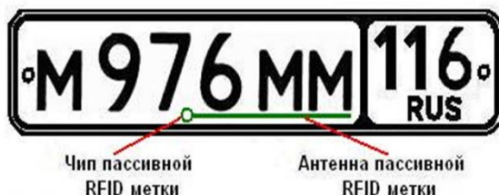
Рис. 1. Номерной знак с меткой и антенным устройством
