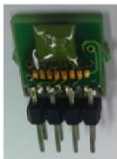
Рис. 2. Фотография макета АМРП с лицевой (а) и обратной стороны (б)
